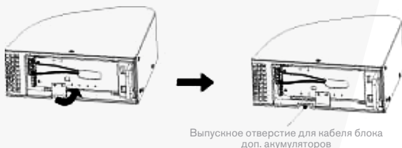
Рис. 9 Снятие направляющих для кабеля
